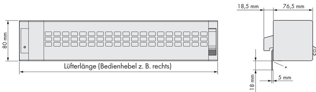
\*Anschlagprofil (Zubehör für Glasfalzeinbau)
